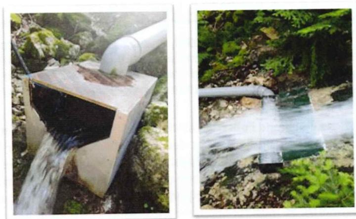
Figure 8 Boite de jaugeage, et passage de l'eau au-dessus du canal de collecte à partir d'un certain débit
