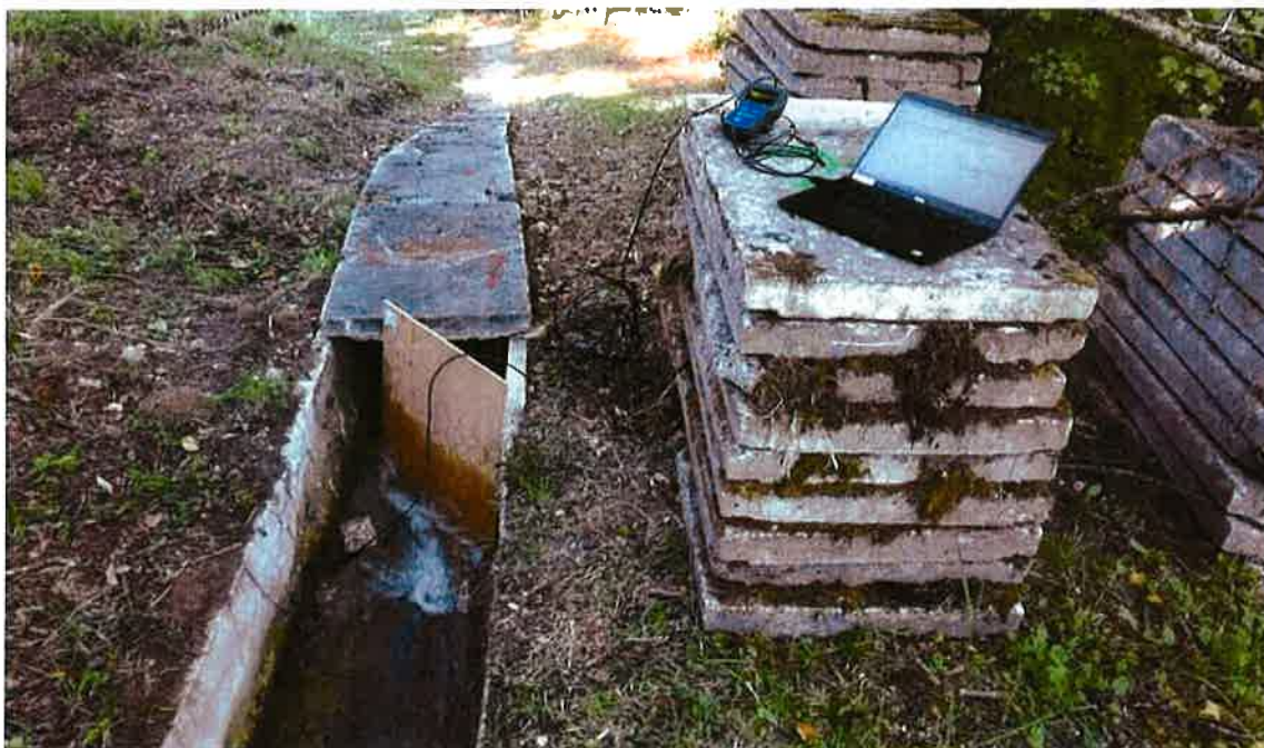
Figure 6 : Site de réalisation des jauges par dilution au sel : mesure de la salinité
