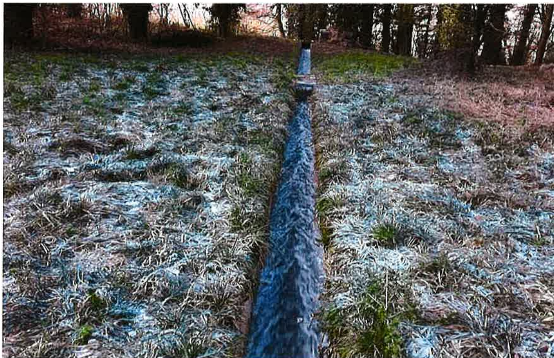
Figure 7 : Site de réalisation des jauges par dilution au sel : injection de sel dans le canal
