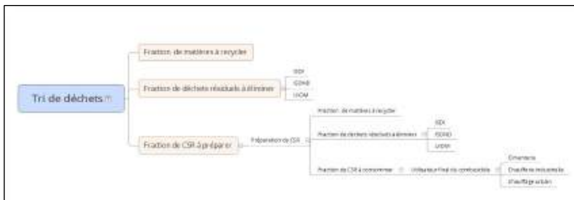
Figure 12 : exemple de process d'installations de tri des déchets d'activités économiques/encombrants préparant des CSR
