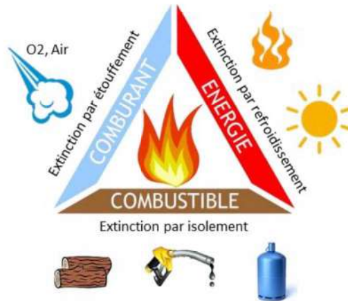
Figure 19 : Triangle de feu : Conditions requises pour qu'un incendie se déclare
