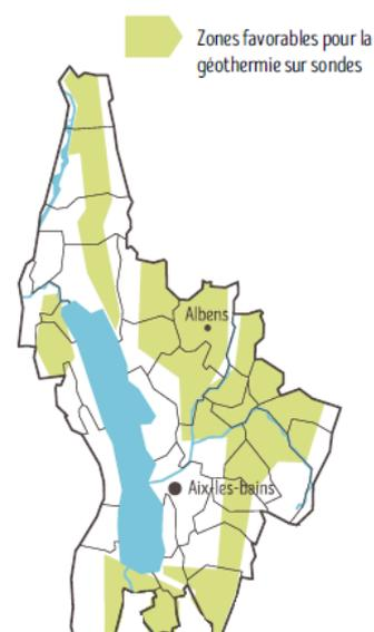
Figure 29 - Zonage des secteurs potentiels pour l'installation de sondes géothermiques.
