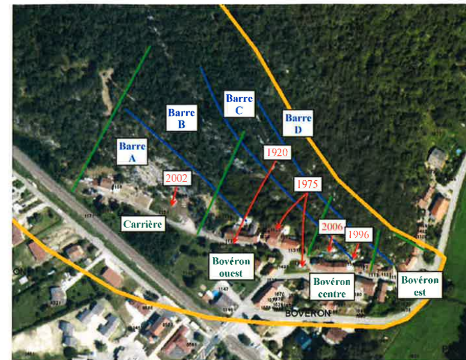
Fig. 1 : orthophoto du secteur de Bovéron, découpé en quatre sous secteurs (en vert), et menacé par quatre barres rocheuses (en bleu). La trajectoire et l'année de chaque chute de blocs recensée sont reportées en rouge. Le périmètre du PIZ figure en orange.
