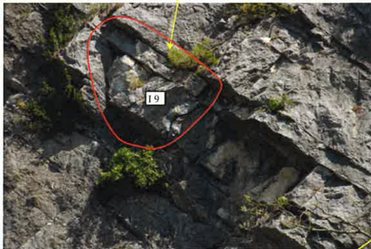
Fig. 19 : vue détaillée de l'instabilité 9 (≈ 0,5 m 3 ) juste à l'amont des blocs éboulés en 2002 (niche visible)
