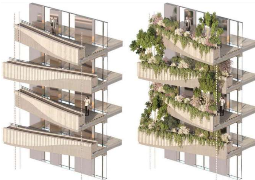
Balcons plantés et chaînes de pluie
