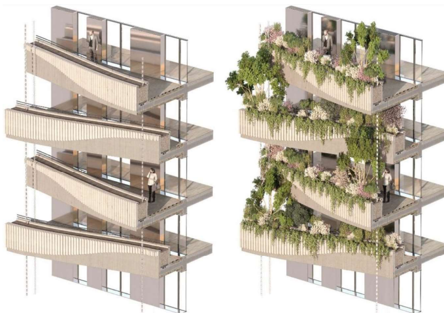
Balcons plantés et chaines de pluie
