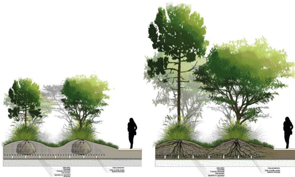
Toiture végétalisée intensive de type jardin – coupe schématique Extrait du Volet Paysage : Phase APD - Permis de Construire Novembre 2020, Sempervierens
