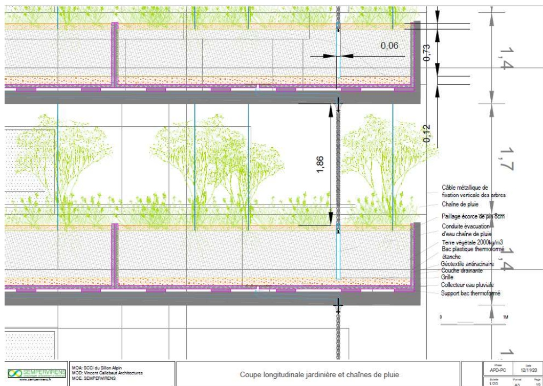
Coupe de principe de jardinière et chaîne de pluie
