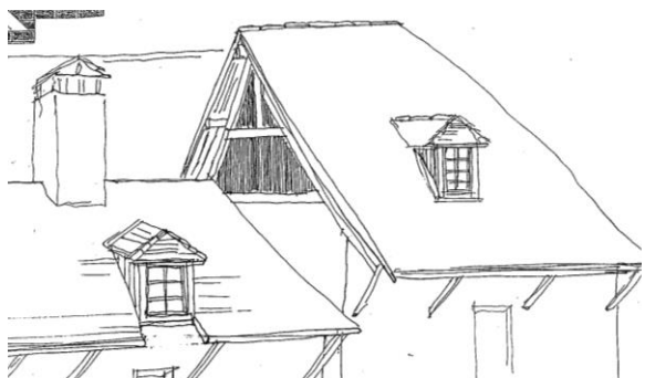
Lucarne pendante à gauche, lucarne en pleine toiture à droite
